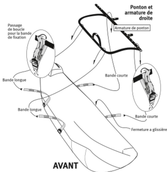
À présent, attachez les deux sangles intérieures et les deux sangles extérieures du ponton à l'armature du ponton. Enfilez les sangles de la façon suivante:
