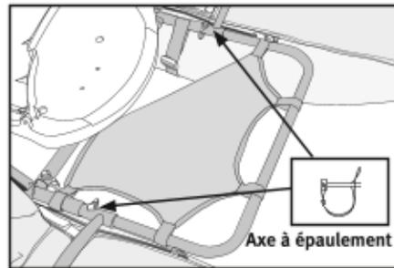
**8b.** Fixez la plateforme de rangement à l'armature en utilisant toutes les boucles carrées comportant des bandes autoagrippantes.
