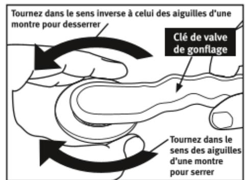
Si vous devez retirer la chambre à air du ponton afin de la réparer, vous devrez complètement dévisser la valve de gonflage de la cage de la valve. Lorsque vous devrez remettre en place la chambre à air, vous pourrez desserrer plus facilement la valve si le ponton comporte déjà de l'air à l'intérieur. Étant donné que l'enveloppe du ponton est prisonnière entre la cage
